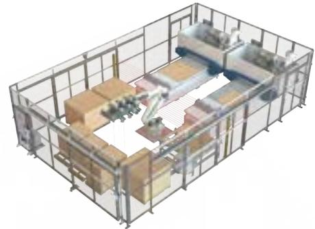
Célula de alimentación CNC con etiquetado automático
