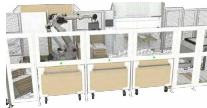
También hemos integrado una variedad de características en la célula. El uso de la seguridad las barreras de luz y la entrada accionada por interruptor garantizan la protección del operador, lo que hace que imposible que un operario entre en la célula mientras ésta está en movimiento.
