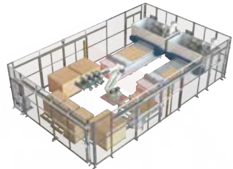
Cellule de service CNC avec étiquetage automatique
